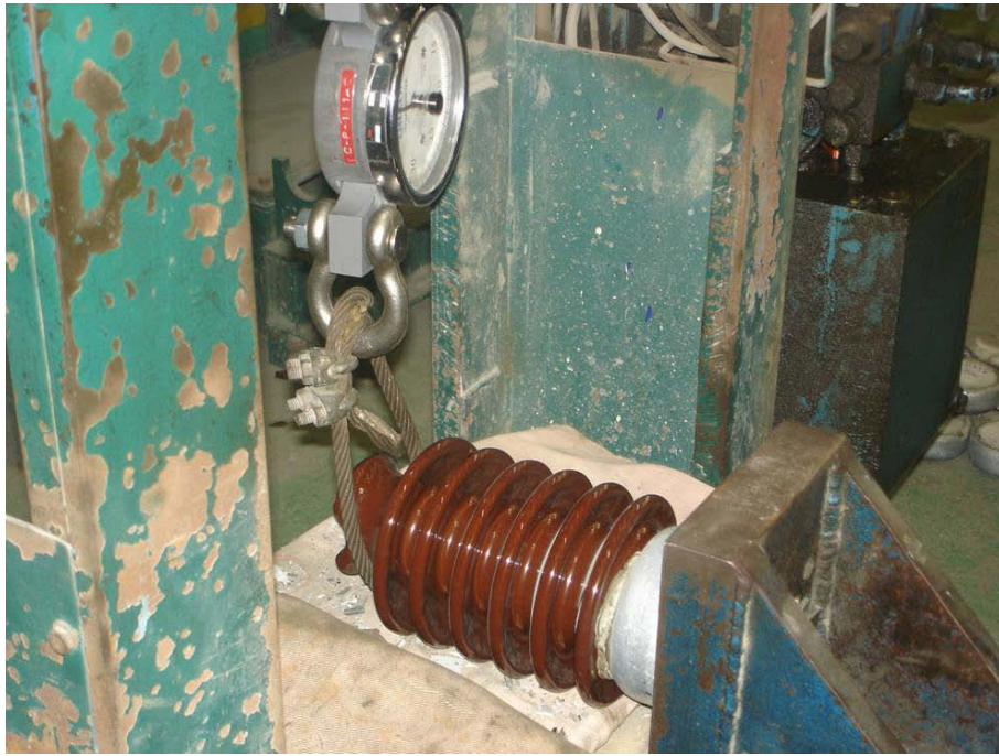
ภาพแสดงการทดสอบหาค่าความแข็งแรงของฉนวนไฟฟ้า
